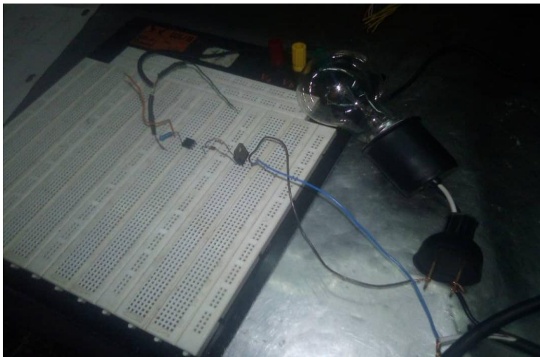
Figura 18. Prueba en protoboard del Sistema Power On
